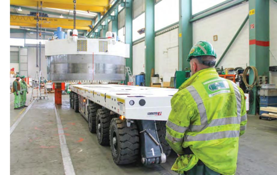
Das 6-Achs-Fahrzeug reiht sich nahtlos ein in die Arbeitsabläufe bei Herrenknecht. „Durch den Eco1000“, beschreibt es Stephan Göggel als Technischer Leiter der Komponentenfabrik, „sind wir bestens gerüstet die bis zu 200 Tonnen schweren Einzelkomponenten unserer Tunnelbohrmaschinen innerbetrieblich zu verfahren.“
