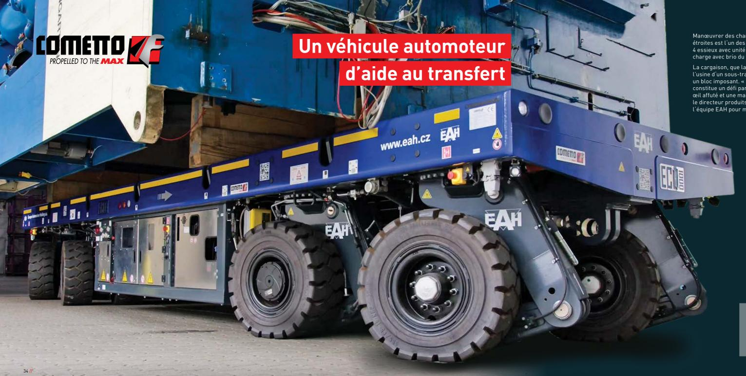
Manœuvrer des charges lourdes et compactes dans des zones de halls étroites est l'un des points forts des véhicules automoteurs. Un Eco1000 à 4 essieux avec unité Powerpack intégrée sous la surface de chargement se charge avec brio du transport d'une presse de 120 tonnes.
